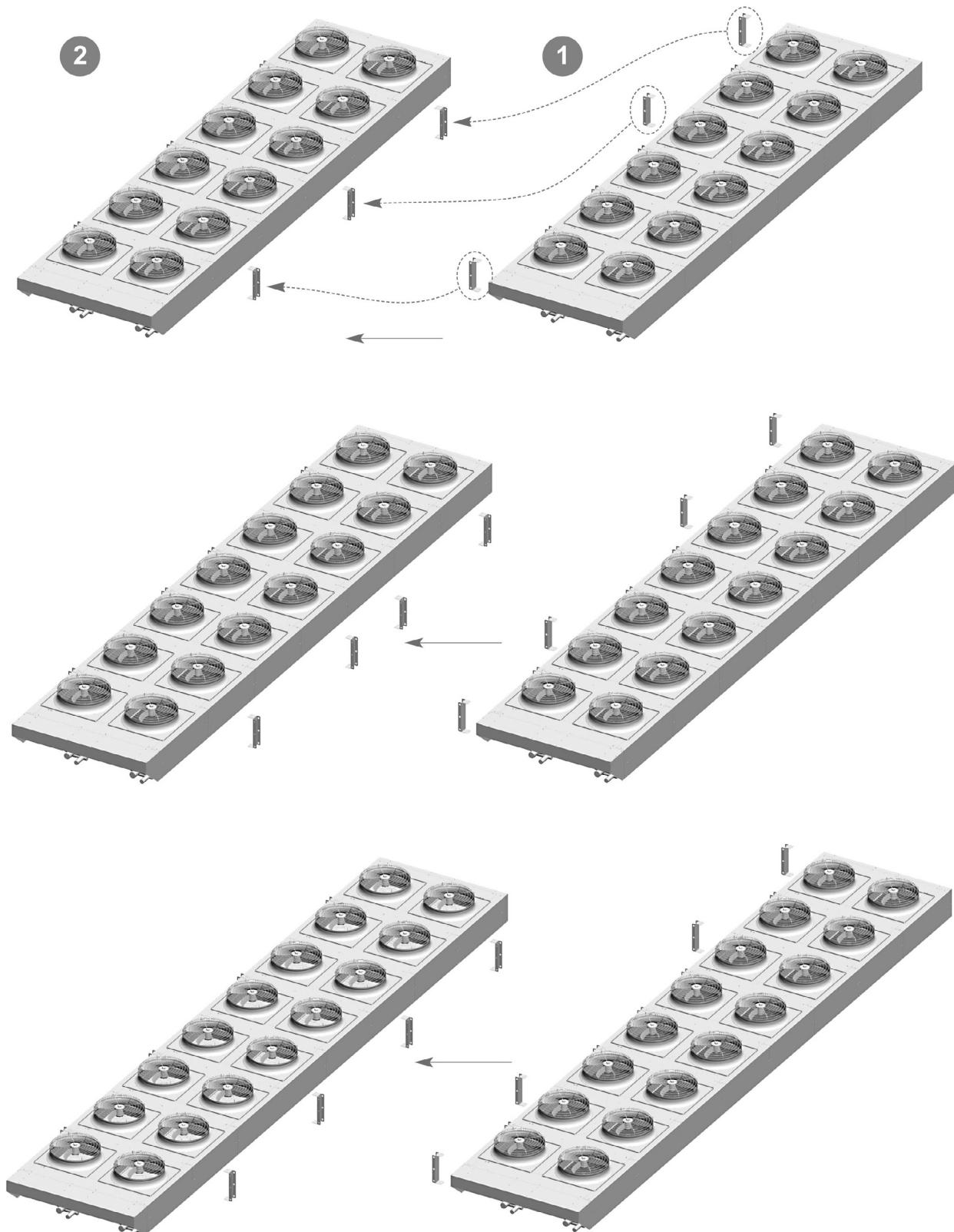
٣.٩.٥ مخطّط ضبط وضعية الدعامات لتدفق الهواء الرأسي
