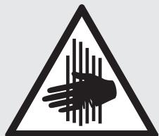
При эксплуатации и очистке оператор должен соблюдать осторожность с оребрением во избежание порезов.
