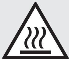
Operatören rör, (i vissa situationer eller under underhållsrepp) avsiktligt eller oavsiktligt, vid en het eller frusen yta: om nödvändigt använd isolerande handskar och/ eller vänta tills ytorna svalnat/värmts upp.
