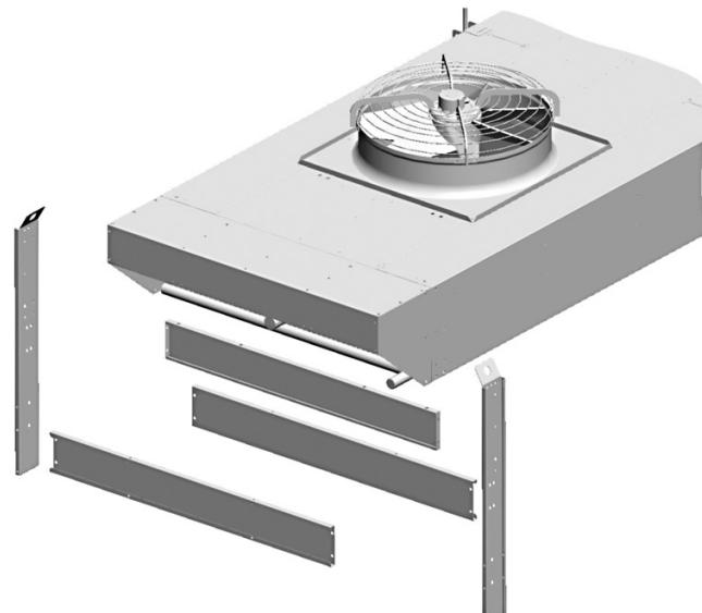
Montera stödfötterna som medföljer som tillbehör, se ritningen som bifogas med modellen och punkt 5.9 för detaljerna. Det är absolut nödvändigt att vidta alla nödvändiga åtgärder för att garantera operatörernas fullständiga säkerhet för att undvika att modellen oavsiktligt faller mot personerna, det är förbjudet att arbeta under en hängande last, det rekommenderas att förbereda en struktur av överlägsen kapacitet för vikten att stödja (bock eller stöttor) som lutar modellen på.
