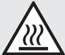
Намеренное или непреднамеренное касание оператором (в особых случаях или при проведении техобслуживания) горячей или заледеневшей поверхности: при необходимости использовать изоляционные перчатки и/или подождать охлаждения/нагрева поверхностей.
