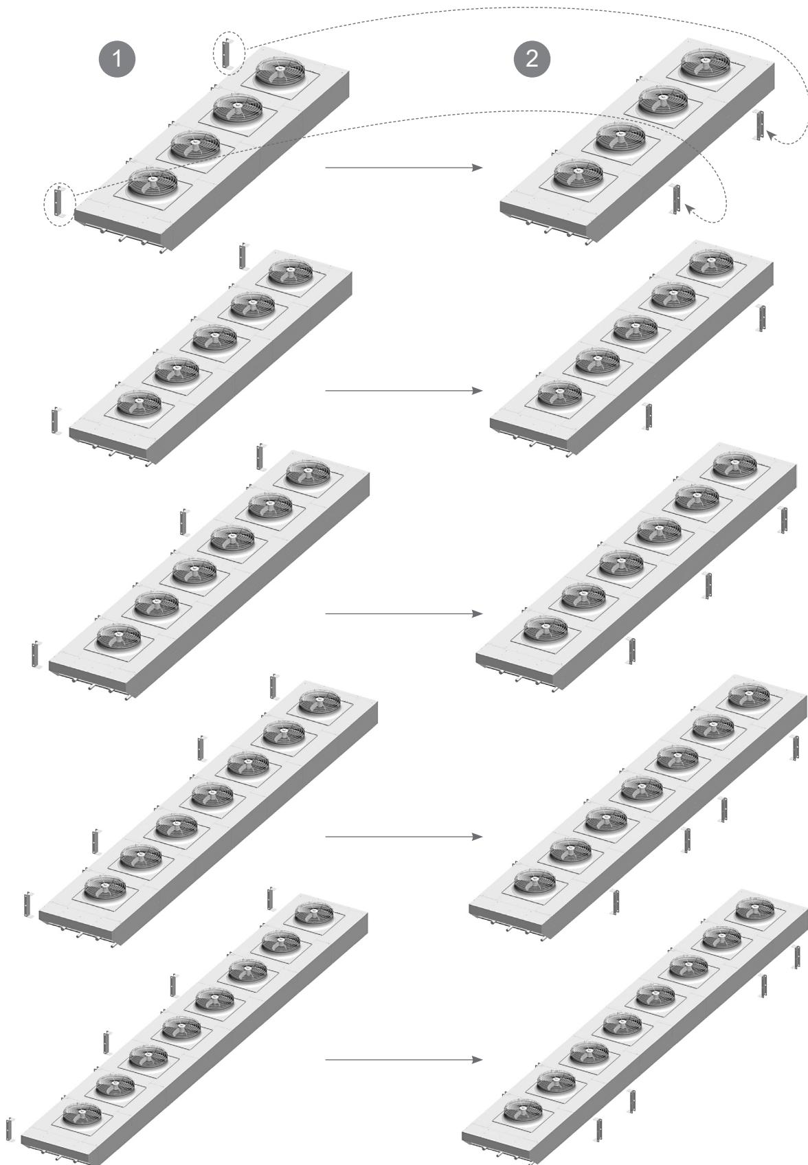
5.9.2 Схема расположения подъемных кронштейнов для вертикального потока воздуха для двух рядов вентиляторов.
