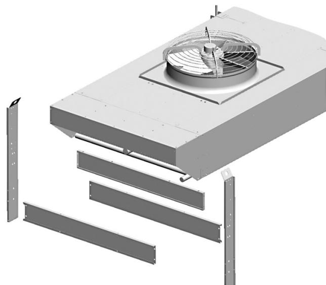
Установите опорные ножки, входящие в комплект поставки, см. прилагаемый чертеж для модели и пункт 5.9 для детальной информации. Необходимо принять все необходимые меры для обеспечения полной безопасности операторов, чтобы избежать случайного падения модели на людей, запрещается работать под подвешенным грузом, рекомендуется подготовить конструкцию, превосходящую по грузоподъемности поддерживаемый вес (подставки или стойки), на которую опирается модель.
