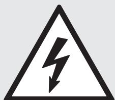
Kontakt med elektriska delar under spänning, under underhållsreppen, som utförs vid närvaro av spänning: procedurer som förbehålls de kvalificerade och auktoriserade operatörerna, eventuellt utrustade med PSU och isolerande redskap - koppla i allmänhet bort elmatningen till maskinen genom att öppna huvudströmbrytaren i läge "O" och låsa den i detta läge.
