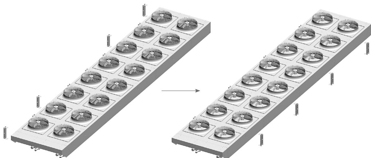
5.9.3 Schema för placering av stödkonsolerna för vertikalt luftflöde.
