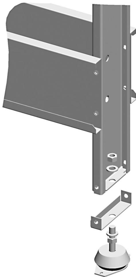
6.6 Предусмотреть необходимое пространство для циркуляции воздуха и для проведения техобслуживания. Избегайте направления воздушного потока на отражающие поверхности или поверхности, повышающие уровень шума. Минимальное пространство между моделями может быть уменьшено, ориентируясь на высоту размещения с использованием специальных подъемных ножек или опорной платформы. Для установки, отличной от указанной, обращайтесь к производителю.
