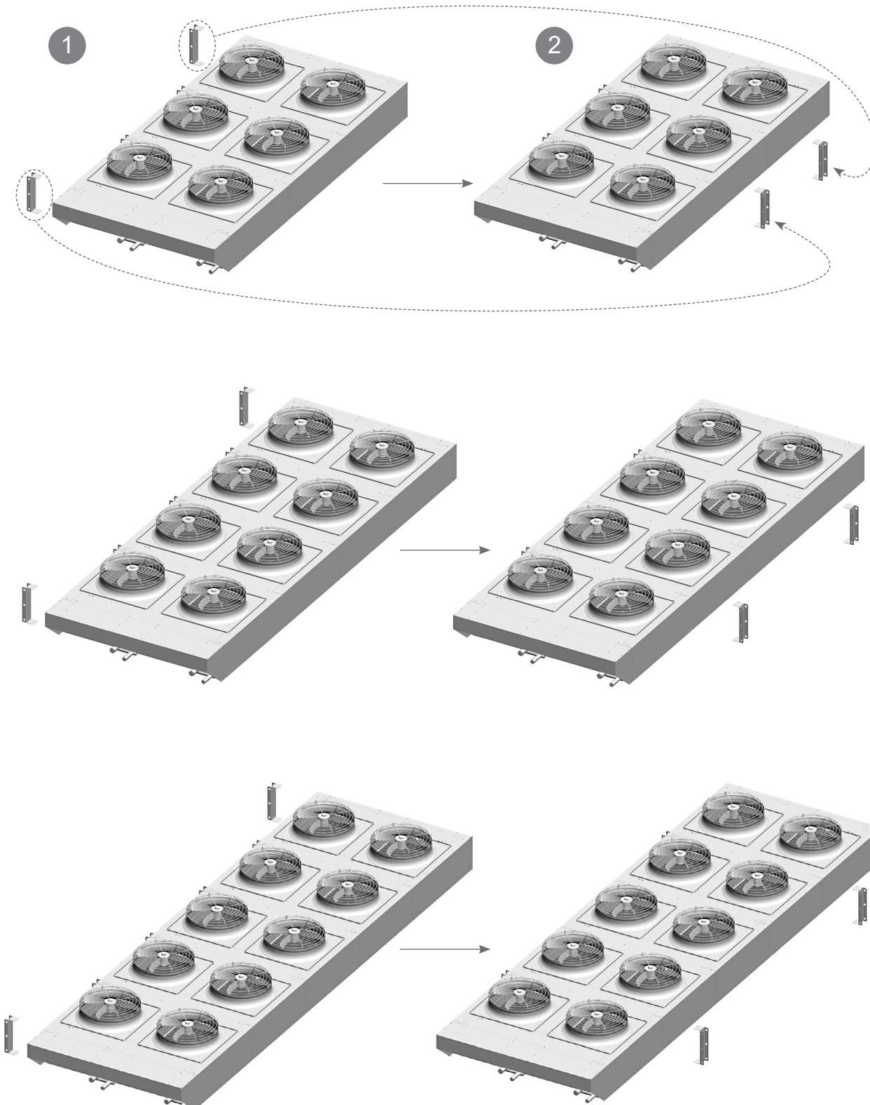
1) Снять как указано, отвинтите 5 винтов для каждой опоры опоры.
