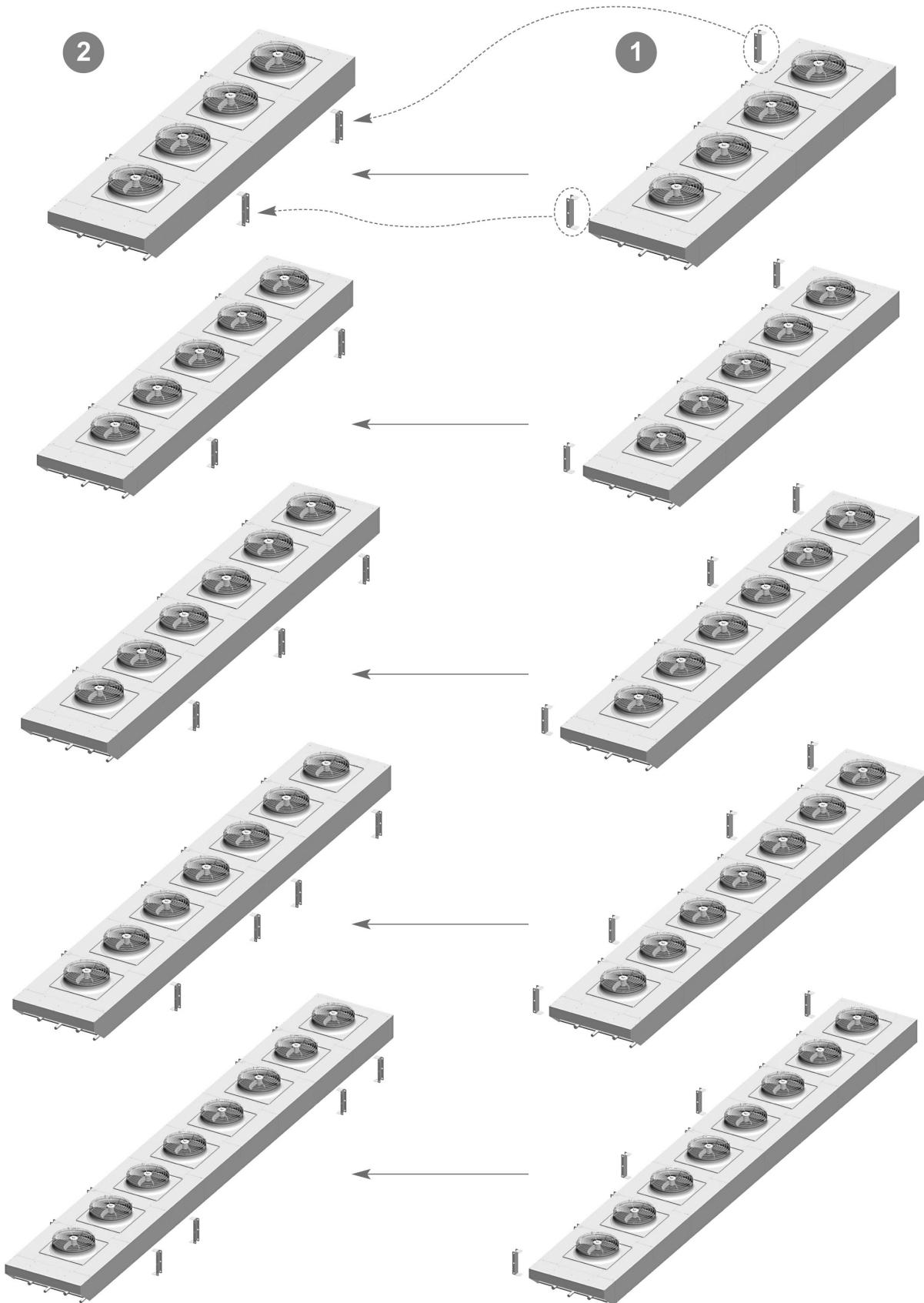
٢.٩.٥ مخطط ضبط وضعية دعامات الرفع لتدفق الهواء الرأسي بصفين من المراوح
