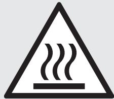
L'opérateur (dans des situations particulières ou durant l'entretien) touche intentionnellement ou non une surface chaude ou gelée: si nécessaire, utiliser des gants isolants et/ou attendre le refroidissement/réchauffement des surfaces.
