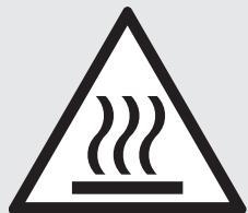
L'operatore (in situazioni particolari o durante la manutenzione) tocca intenzionalmente o non intenzionalmente una superficie calda o gelata: se necessario usare guanti isolanti e/o attendere il raffreddamento/riscaldamento delle superfici
